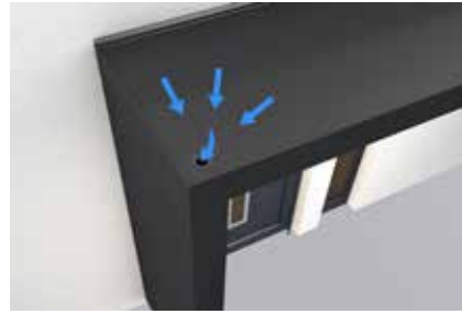
Dachdurchführung mit Wasserabführung im Seitenteil
